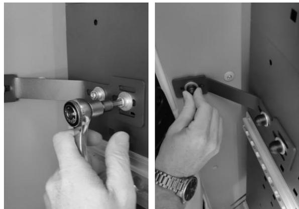
Geben Sie Schraubensicherung in das Gewinde des Originalbefestigungspunktes in der Karosserie.
