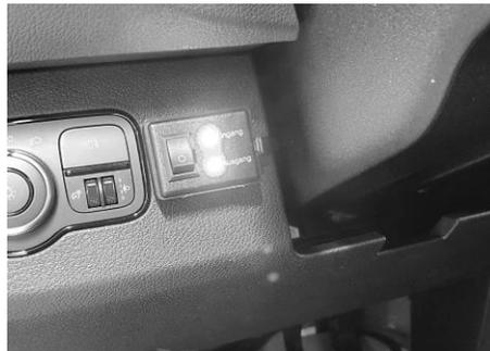
**Wenn Sie die Fernbedienung nutzen muss der Ein/ Aus Schalter des Spannungswandlers auf OFF stehen.**
