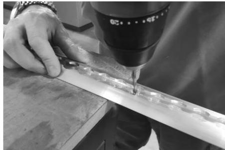
Bohren Sie Bohrungen mit  $D = 5,0\text{mm}$
