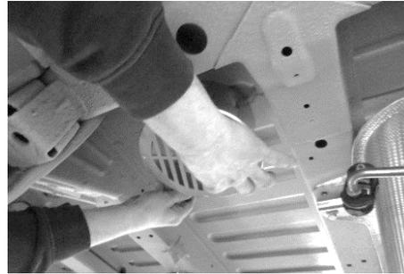
Markieren Sie die Position mit einem Stift. Sie können einen Kreis um den Zylinder des Lüfters ziehen.
